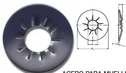
ACERO PARA MUELLES HRc 40÷50 (HV 400-510) Aceitado Antioxidante
